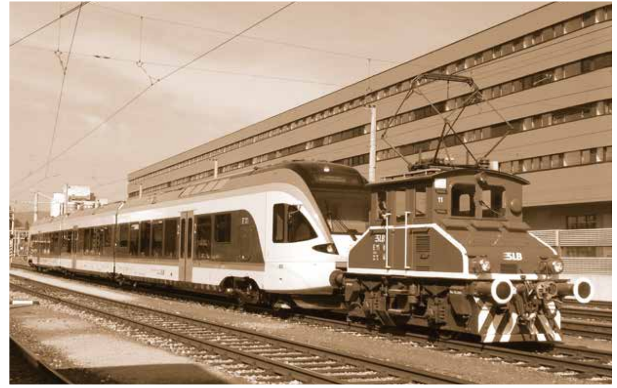
Heute das Haupttätigkeitsfeld der 100-jährigen Lokomotive, der Vershub der Wechselstromtriebwagen der Berchtesgadener Land Bahn (BLB) im Gleichstrombereich der Salzburger Lokalbahn
