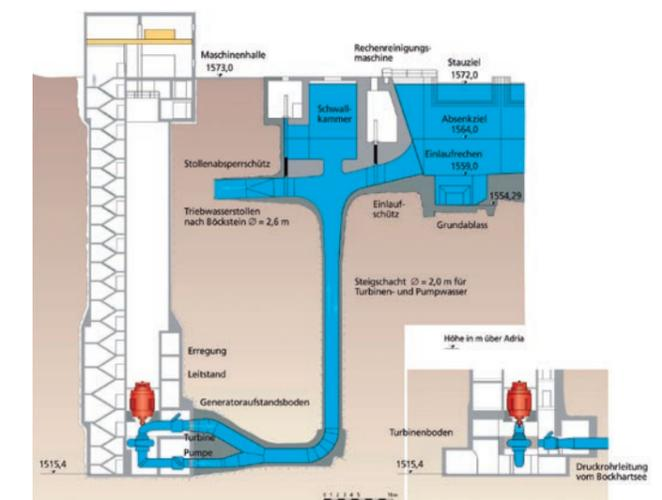
Beim Kraftwerk Naßfeld wurden 14 Geschoße des Krafthauses fast 60 Meter tief in den Fels gebaut.
