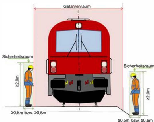
Bild 1: Gefahrenraum und Sicherheitsraum
